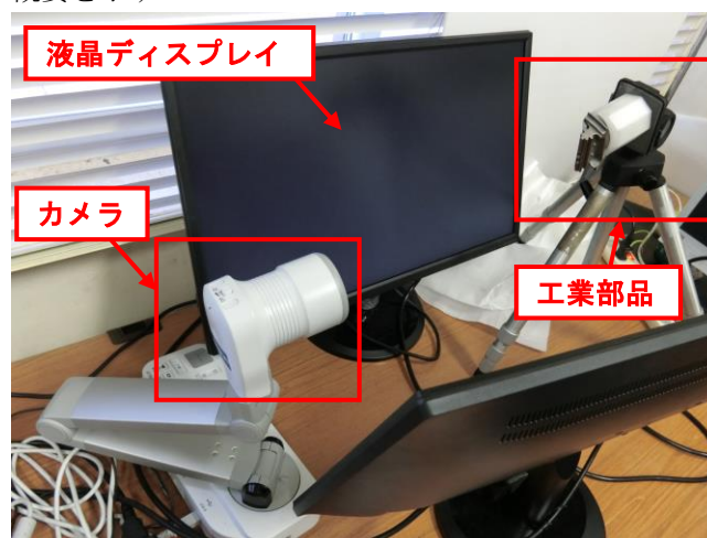
図1 プロジェクションマッピング照明実験装置
