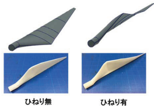
図 4. QBlade を用いて設計した 3D データと製作物 上側：QBlade を用いて設計した 3D データ 下側：3D データを基に 3D プリンタで製作したものの
